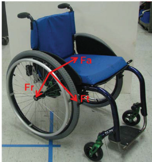
Figura 5. Componentes da força aplicada ao aro. Ft = Força tangencial; Fa: força axial; Fr: força radial.
