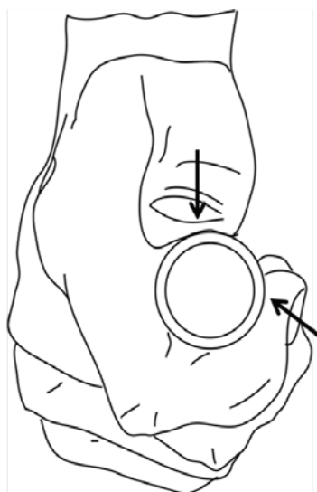
Figura 2. Interface entre aro e mão: seção transversal demonstrando os principais pontos de contato (Modificado de: Medola et al., 2012).
