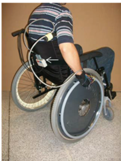
Figura 4. Localização dos componentes do sistema de coleta na cadeira de rodas: seta indica o dispositivo de aquisição de dados.
