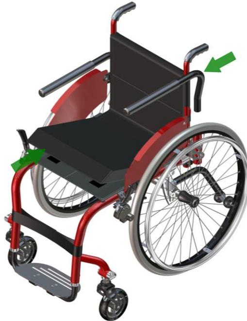
Figura 1.1- Indicação de quais componentes devem ser removidos
