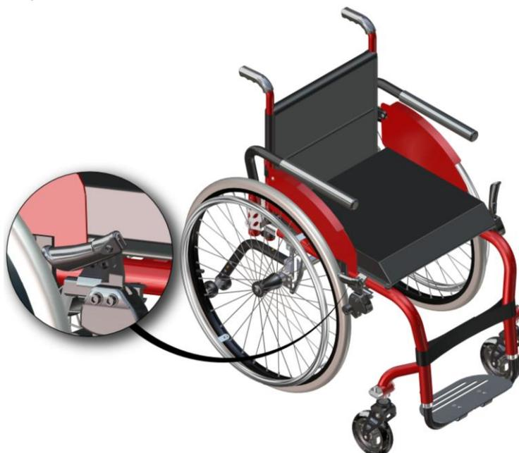
Figura 7.3-A alavanca do freio escamoteada
